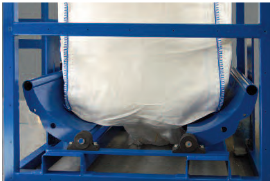
▲ Pneumatische Entleerhilfen für Big-Bags Pneumatic discharge cylinder for Big-Bags
