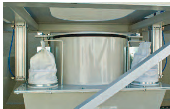
▲ Staubfreie Ankoppelung von Big-Bags Dust-free connection of Big-Bags
