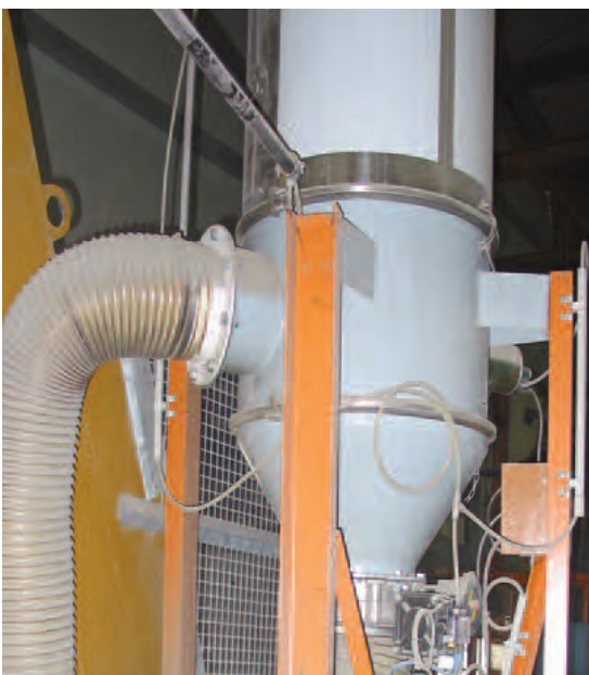
▲ Mischerentstaubung mit Filterreinigung durch Luftschock Dust filter with reverse air shock filter cleaning
