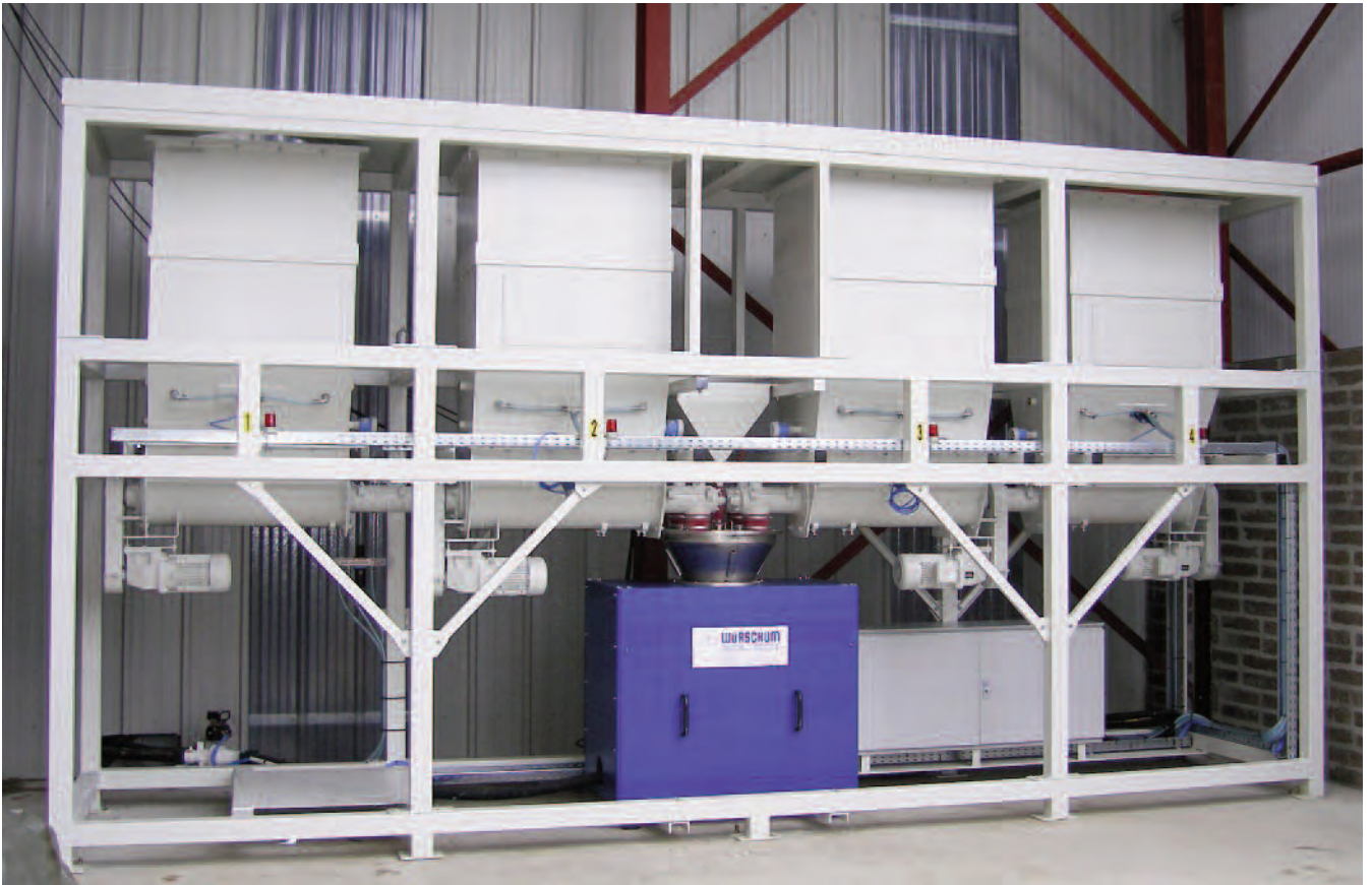
▲ FLEX 70 Pulverdosierung für vier Farben mit Behältervergrößerung zur Aufnahme eines ganzen Big-Bag
