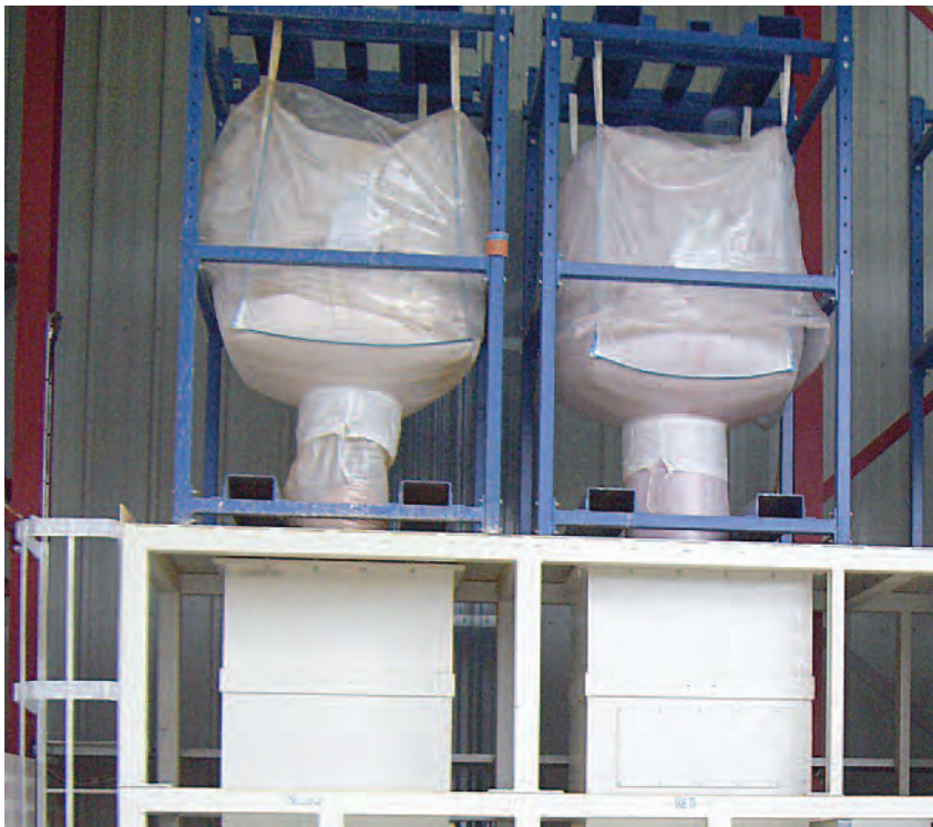
▲ Behältervergrößerung mit zusätzlichem Big-Bag Hopper extension with additional Big-Bag
