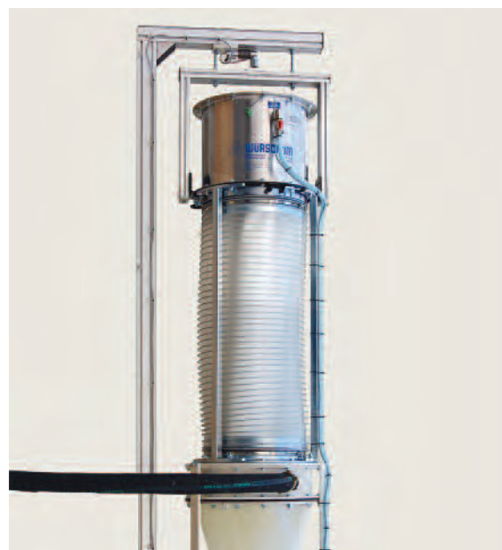
▲ Filterzyklon mit Filterreinigung durch Luftschock Filter cyclone with reverse air shock filter cleaning
